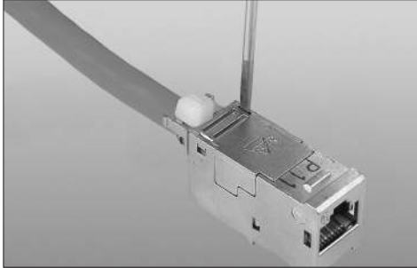
Ladestück mit einem kleinen, flachen Schraubendreher entriegeln ... Unclip the loader using a small, flat-bladed screwdriver ...
