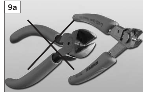
Zum Entfernen der überstehenden Adern einen geeigneten Seitenschneider verwenden ... Use an appropriate wire cutter to cut the excess length of the wires ...
